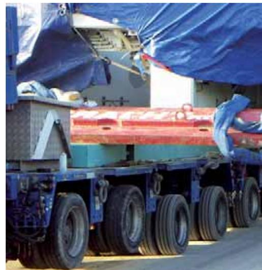
*Verladung eines Turmsegments in Cuxhaven. Der gesamte Turm besteht aus vier Sektionen und wiegt 741 Tonnen.*
