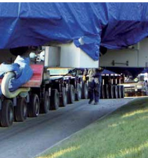
*Spezialtransporter mit 22 Achsen für den 212 Tonnen schweren Generator der E-112*
