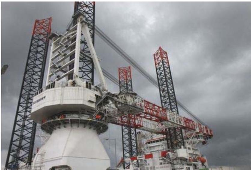
Das 147,5 Meter lange und 42 Meter breite Schiff ist mit einem Liebherr-Kran bestückt, der 1.500 Tonnen heben kann. Bild: J.Hadel
