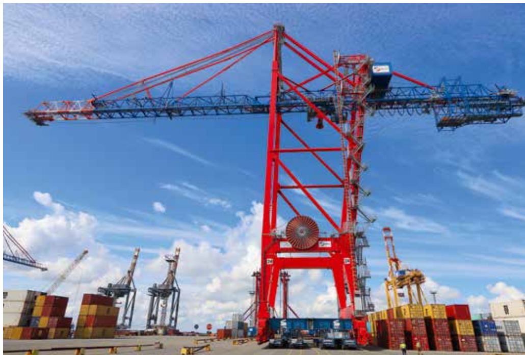
Mit Abmessungen von 136,6 x 20,2 x 91,8 (L x B x H) Metern sind die neuen Containerbrücken für Hamburg unübersehbar.
