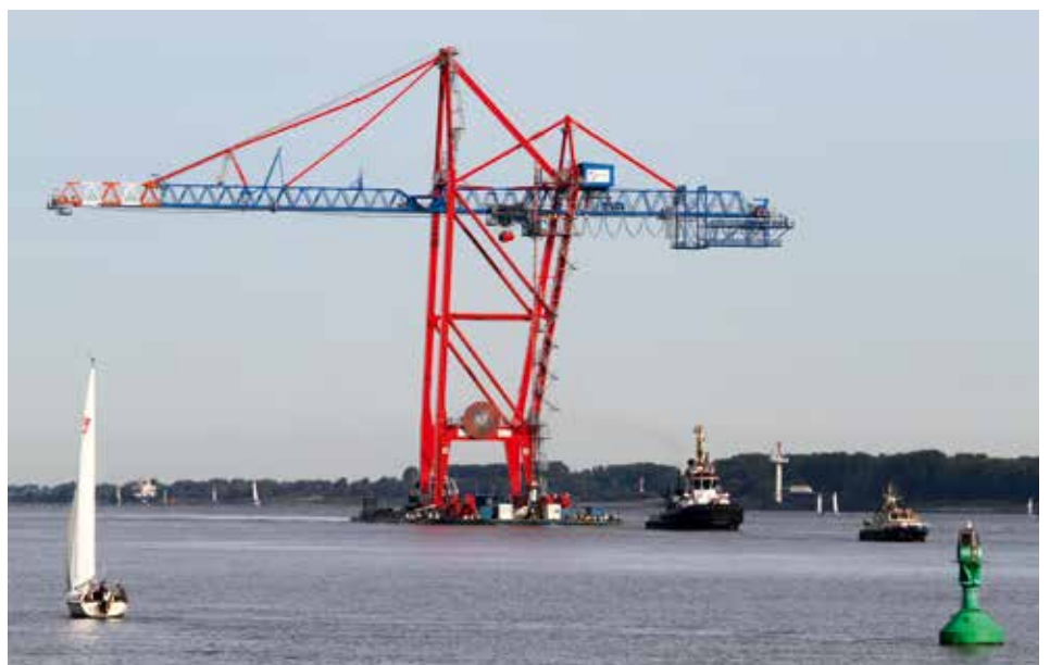
Zwischen Stade und Hamburg ist die Barge „Caroline“ soweit wie möglich ballastiert und bis auf Wasserpegel herabgelassen.
