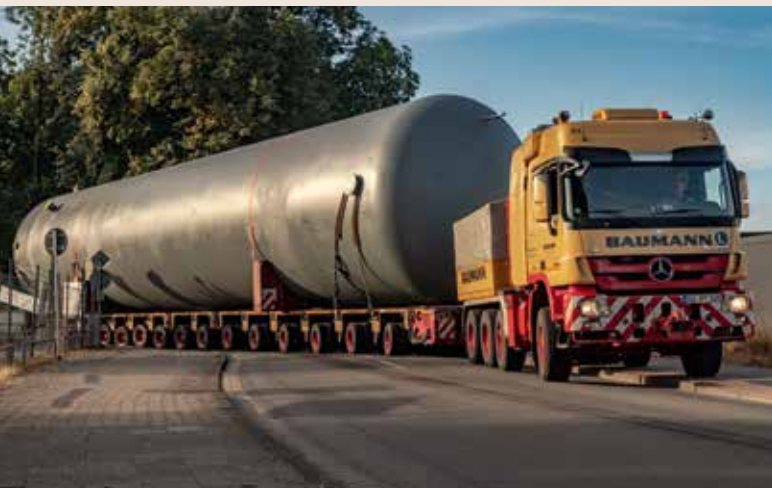
Jeweils 35 m lang waren die Gespanne, die auf die Tanks für die Wärmespeicheranlage transportiert wurden.
