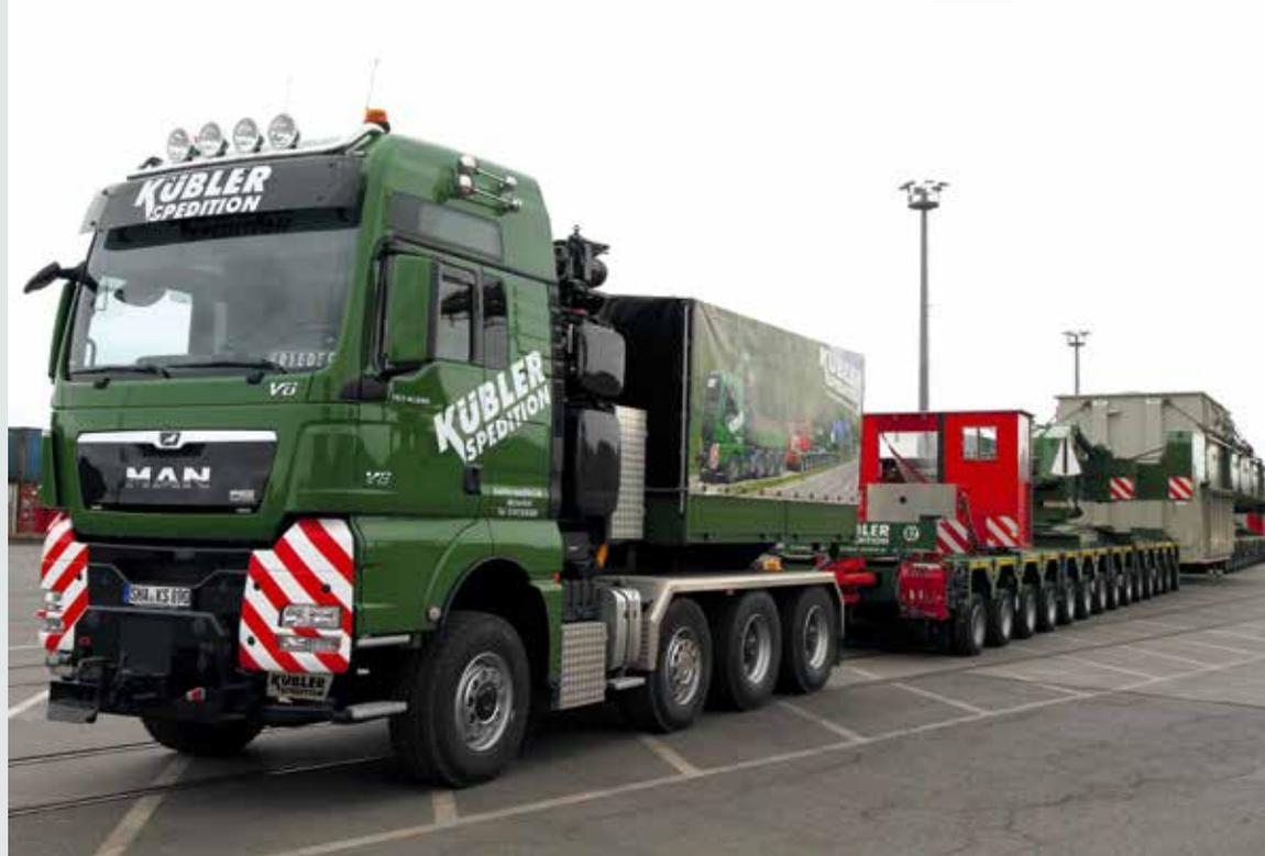
ohne Z-Träger die beiden 14-achsigen Scheuerle-Module in einer geraden Linie miteinander verbinden. Zusammen mit den beiden 4-achsigen Zugmaschinen kommt ein Gesamtgewicht von über 470 t zusammen.
