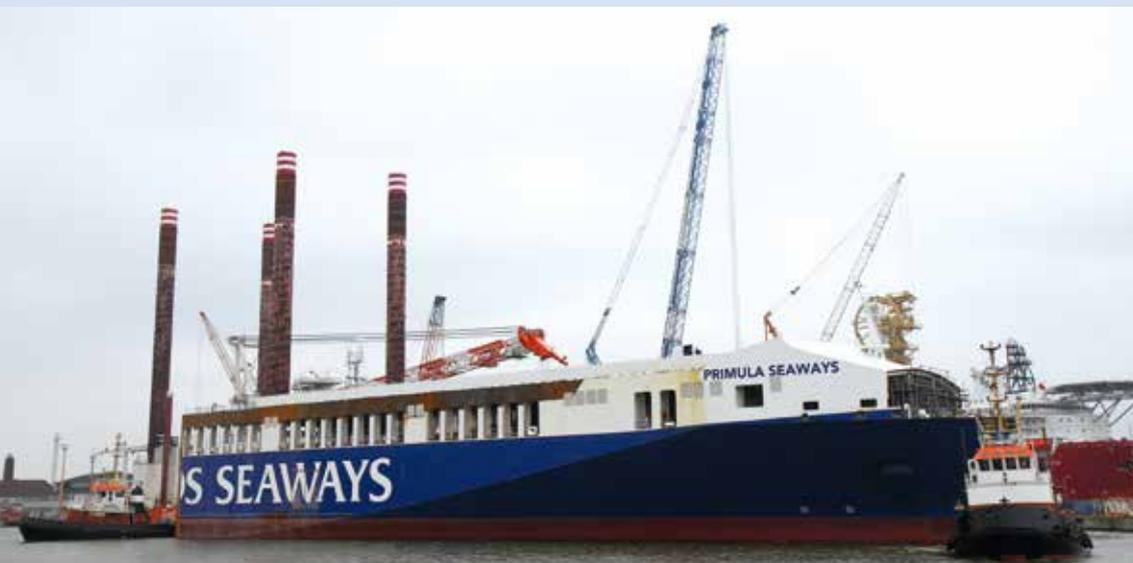
Das abgetrennte Vorschiff wird zum Dock III bugsiert.
