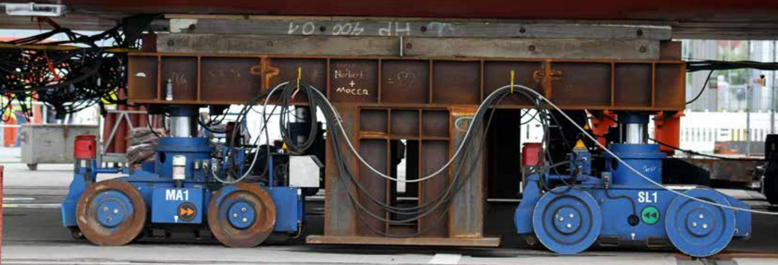
man die Dimension der Aufgabe. Und bei allen Transportetappen darf die Verlängerung nicht verzogen oder verformt werden, denn spätestens bei der späteren Hochzeit mit der „zersägten“ Primula Seaways gäbe es sonst große Probleme.
