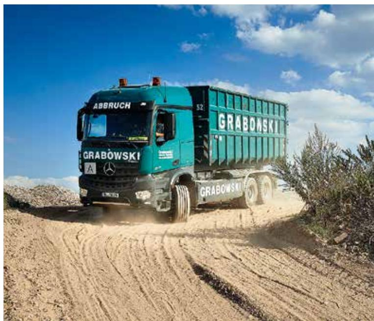
Truck zieht im Abbruch-Alltag der Grabowskis einen Langdorf-Hinterkipper. Vor oder nach den Abbrucheinsätzen sattelt Arocs-Fahrer Frank Langbehn um und schiebt die Zugmaschine mit ihrer doppelt gesicherten Schwerlast-Spezialkupplung unter einen Tieflader. Das Gespann ist dann für 56 t Gesamtzugmasse einsetzbar und kann damit schweres Gerät zu den Einsatzorten und wieder zurückbringen.
