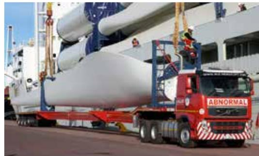
Nootboom liefert an ALE für den Transport von Windkraftanlage-Teilen mehr als 16 Fahrzeuge, darunter ein 4-achsiger, dreifach teleskopierbarer Telestep.
