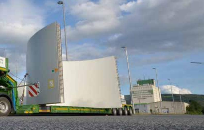
Fahrzeug-Lösungen für Rotorblätter von 55 bis 85 m. Bei Offshore-Anlagen liegen die Stück-Gewichte derzeit bei circa 235 t (zum Beispiel 6 MW-Anlagen). Dies ist nur mit Spezial-Fahrzeugen und ausgesuchten und genehmigten Strecken ans Ziel zu bringen.“
