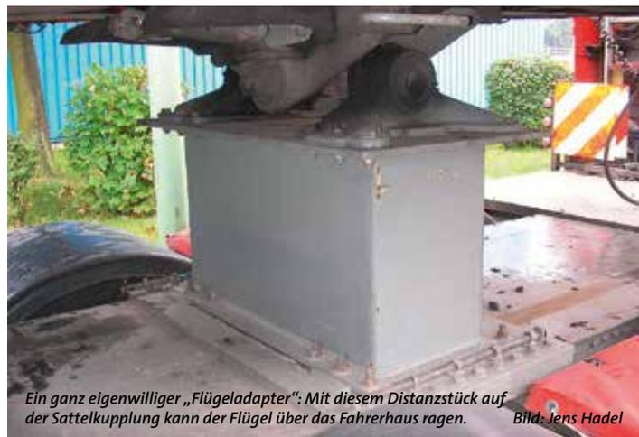
Ein ganz eigenwilliger „Flügeladapter“: Mit diesem Distanzstück auf der Sattelkupplung kann der Flügel über das Fahrerhaus ragen. Bild: Jens Hadel
