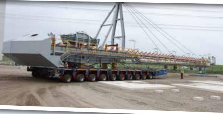
der 48 Meter lange Abwurfausleger auf dem parallel gekuppelten Selbstfahrer in Bewegung. Die Wendigkeit der THP-Achsen erlaubte das zügige Verlassen des Hafens.
