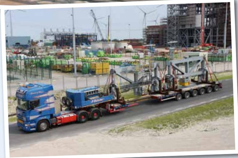
mit zwei parallel gekuppelten 10 THP Achsmodulen verladen. Durch den sehr einseitigen Schwerpunkt des rund 48 Meter langen Elements hingen über 30 Meter des Förderbands in Fahrtrichtung über den Selbstfahrer. Schon während der ersten Rangierfahrten im Hafen zeigte sich, dass ein solcher Überhang einen entsprechend großen Schwenkbereich zur Folge hat.
