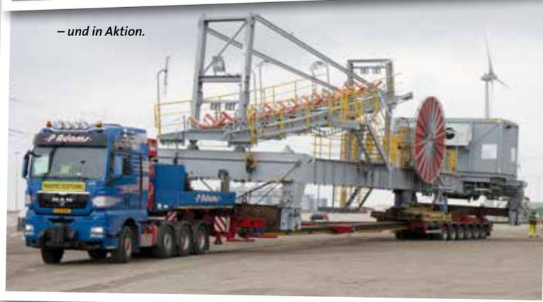
eine Ende des Gerüsts auf einem Drehschemel. Ein vierachsiger Nachläufer mit Drehschemel führte das andere Ende der Brücke hinterher. Diese Lösung erlaubte durch die hohe Lagerung der Ladung eine problemlose Fahrt durch alle Engstellen. Vom MAN TGA 41.660 gezogen, rollten 10 parallel gekuppelte Goldhofer-Achslinien mit dem 115 Tonnen schweren Portal vom Hafen zur Baustelle. Besonders die Höhe der Ladung von fast
