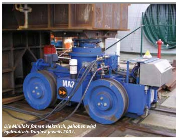
Die Miniloks fahren elektrisch, gehoben wird hydraulisch: Traglast jeweils 200 t.
