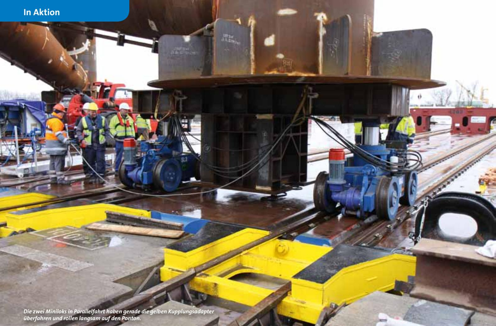
Die zwei Miniloks in Parallelfahrt haben gerade die gelben Kupplungsadapter überfahren und rollen langsam auf den Ponton.
