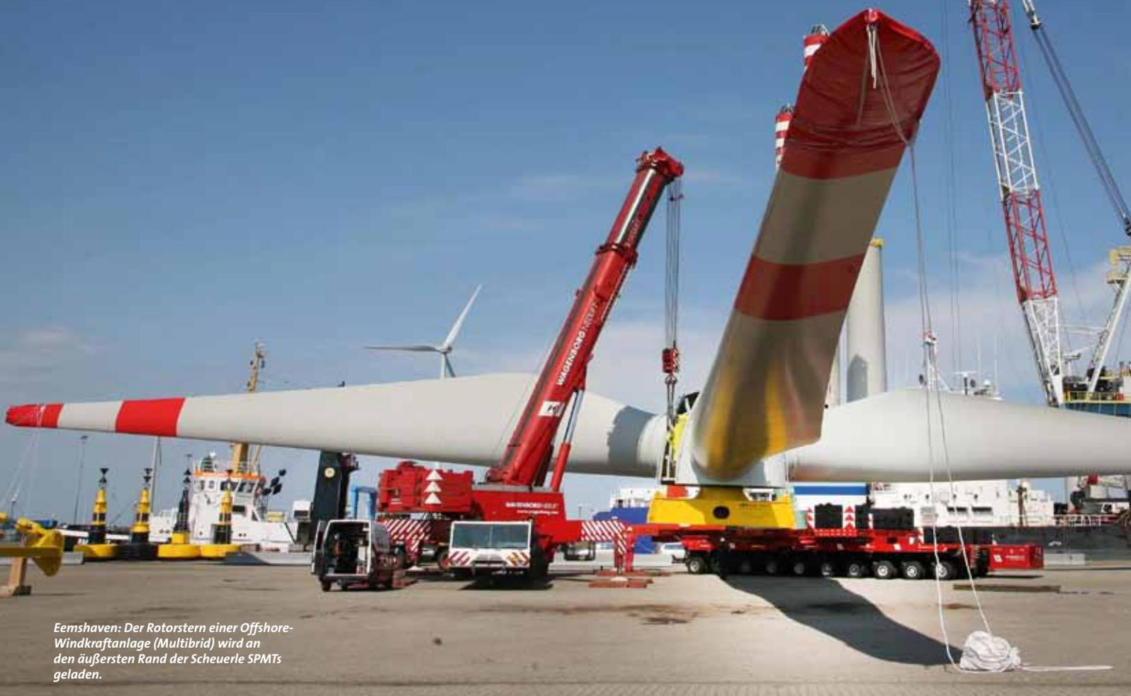
*Eemshaven: Der Rotorstern einer Offshore-Windkraftanlage (Multibrid) wird an den äußersten Rand der Scheuerle SPMTs geladen.*
