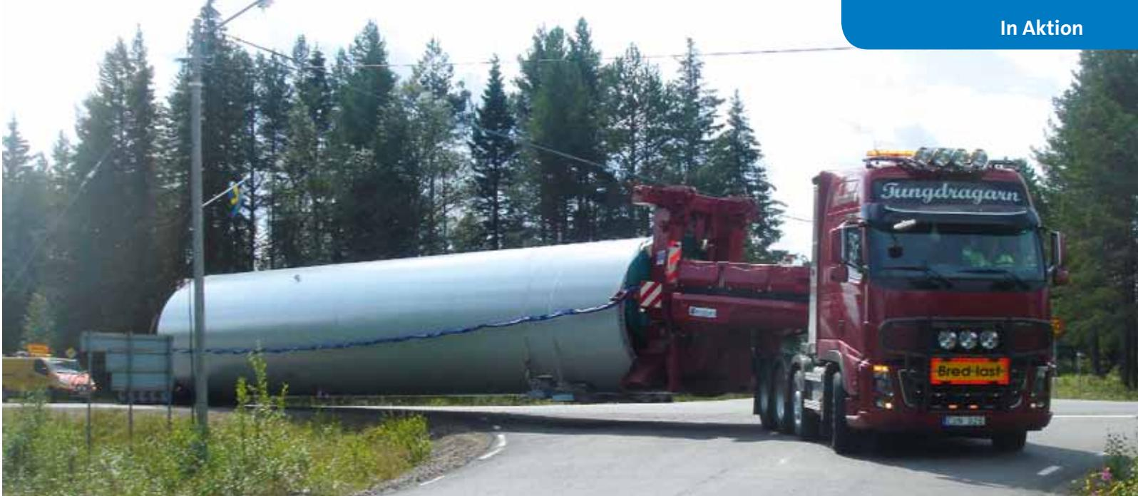
Nicolas Windturmadapter beim Transport eines Windturms der Firma Enercon (Länge: 25,2 m; Durchmesser: zwischen 2,9 – 4,26 m; Gewicht: 59 t). Diese Windkraftanlage ist Teil eines riesigen Windparks in Schweden. Insgesamt werden dort 1.101 Windkraftanlagen installiert.
