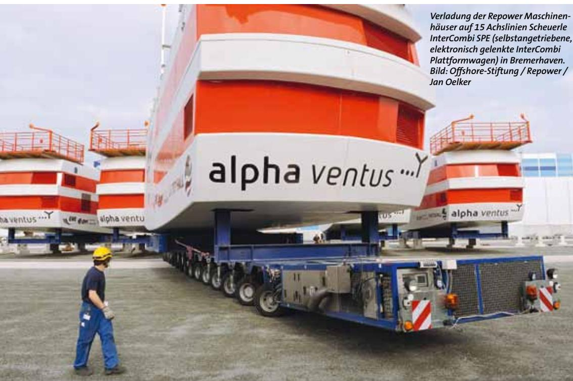
*Verladung der Repower Maschinenhäuser auf 15 Achslinien Scheuerle InterCombi SPE (selbstangetriebene, elektronisch gelenkte InterCombi Plattformwagen) in Bremerhaven. Bild: Offshore-Stiftung / Repower / Jan Oelker*
