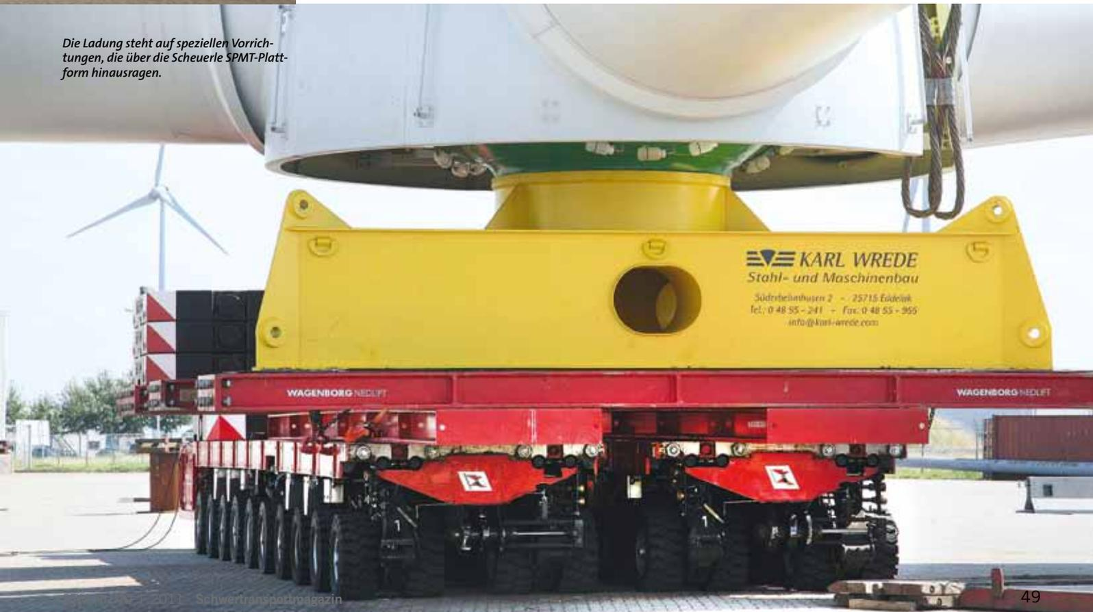
Ein Maschinenhaus der Firma BARD auf 2 x 20 Achslinien Scheuerle SPMT in 4-file Kombination, angetrieben von 2 PPU's (PowerPack Units).
