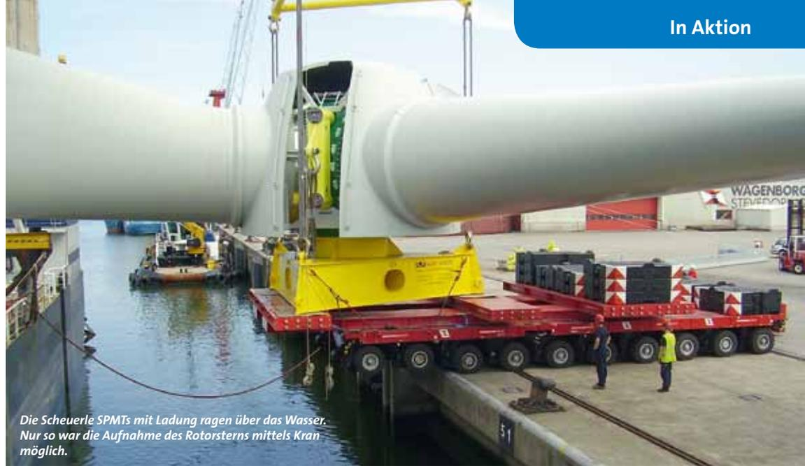
Die Scheuerle SPMTs mit Ladung ragen über das Wasser. Nur so war die Aufnahme des Rotorsterns mittels Kran möglich.
