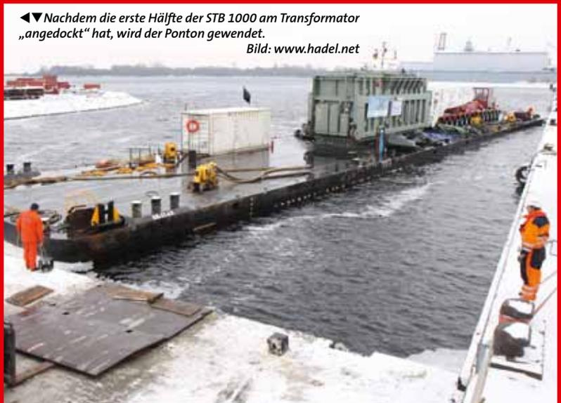
◀◀ Nachdem die erste Hälfte der STB 1000 am Transformator „angedockt“ hat, wird der Ponton gewendet. Bild: www.hadel.net
