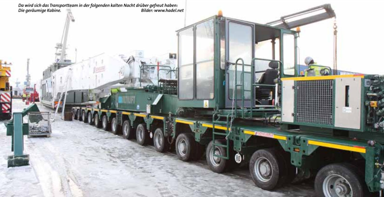
◀ Die STB 1000 mit dem Transformator ruht auf Stützen, während die Transporteinheit mit zusätzlichen Achsen aufgerüstet werden.
