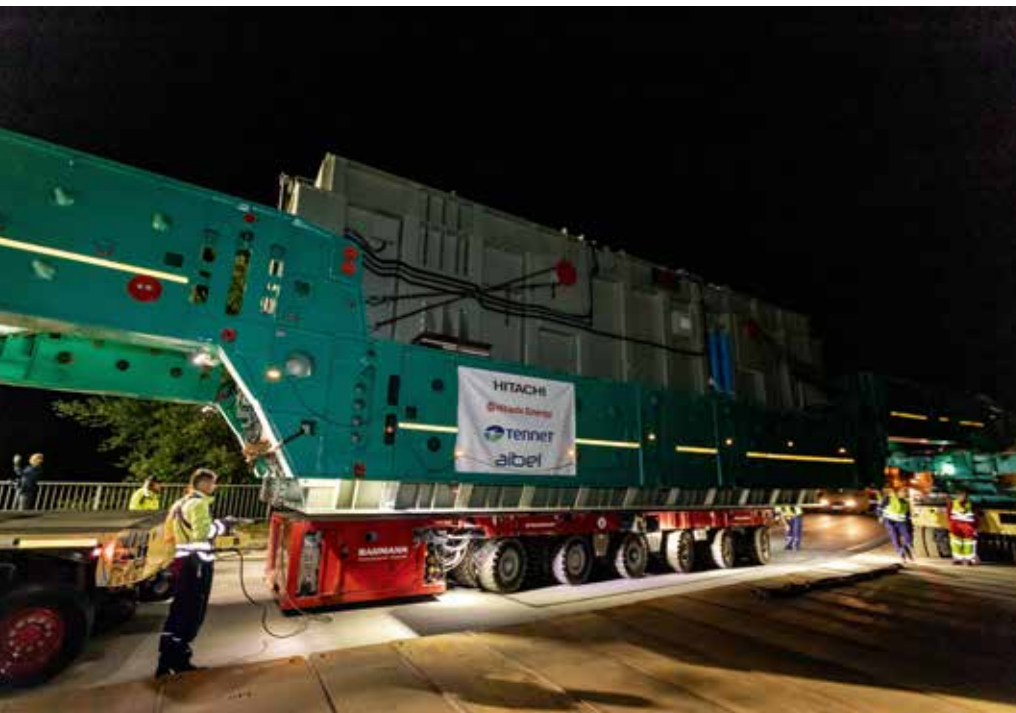
Ein fünfachsiges Selbstfahrer wird für die Fahrt über die erste Brücke unter dem Trafo platziert.
