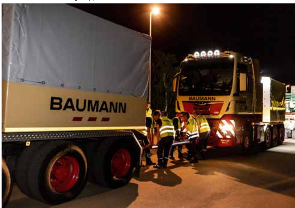
... anschließend zügig mit einer stabilen Schleppstange die Verbindung zum Schwertransport hergestellt.
