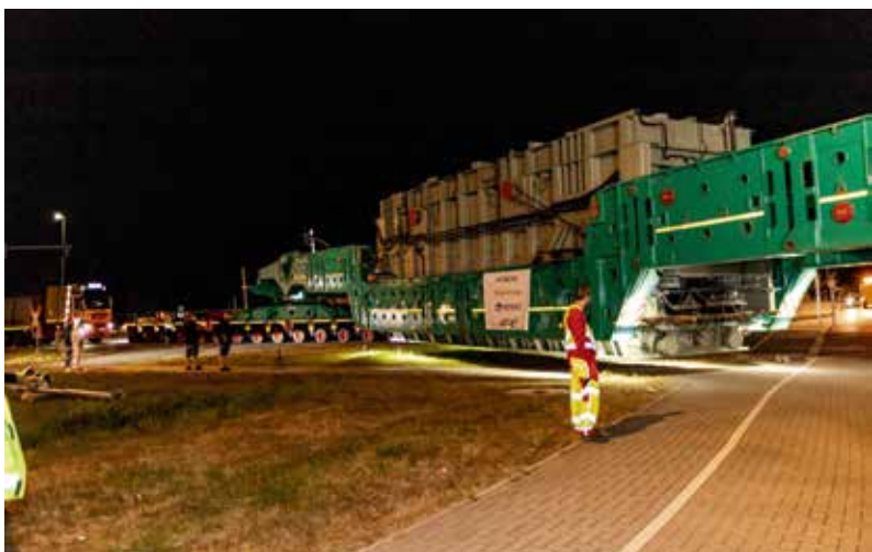
Der 416 Tonnen schwere Trafo schwebt über den Boden und „schneidet“ die Kurve.
