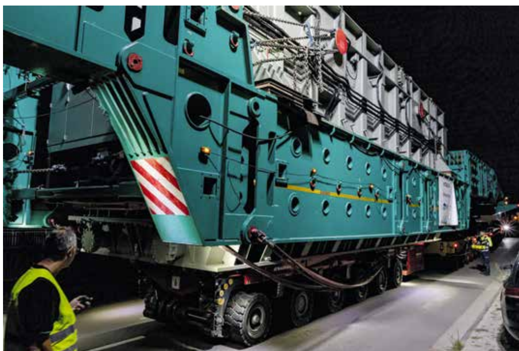
Bei der Fahrt über die Brücke waren auf beiden Seiten noch jeweils zwei Hochleistungsroundschlingen als Sicherung zwischen Selbstfahrer und dem Rahmen der Scherenhub-Kesselbrücke angeschlagen.
