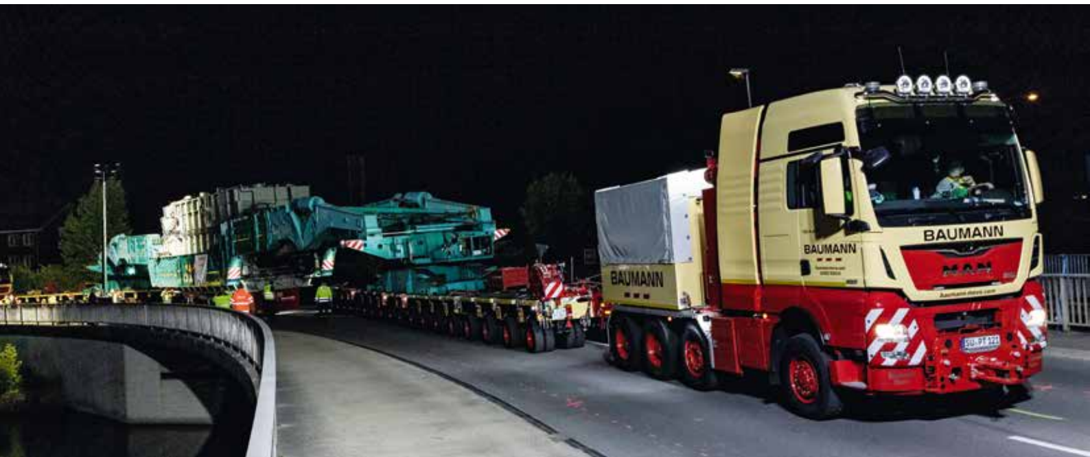
Die Antriebskraft der beiden 8x6-Boliden wird hier nicht benötigt. Nur mit der Kraft der Scheuerle-Achslinien wurde die Brücke überquert.
