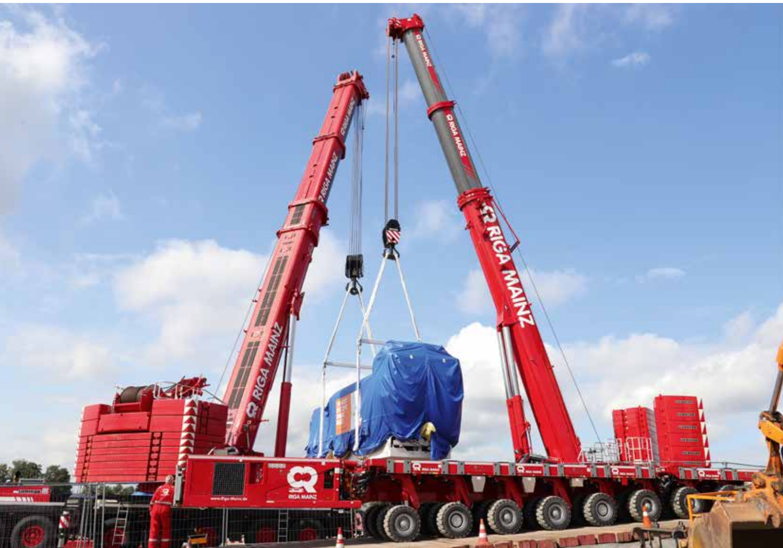
Gut zu sehen, wie die Achsen des SPMTs die vorhandene Schräglage ausgleichen.
