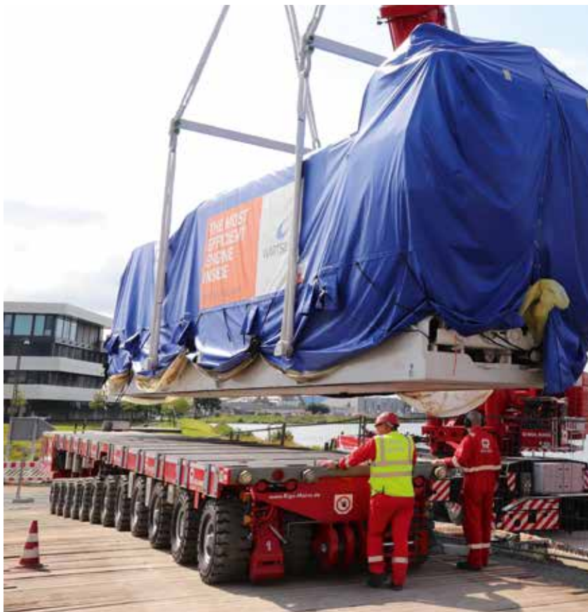
Gut zu sehen, wie die Achsen des SPMTs die vorhandene Schräglage ausgleichen.
