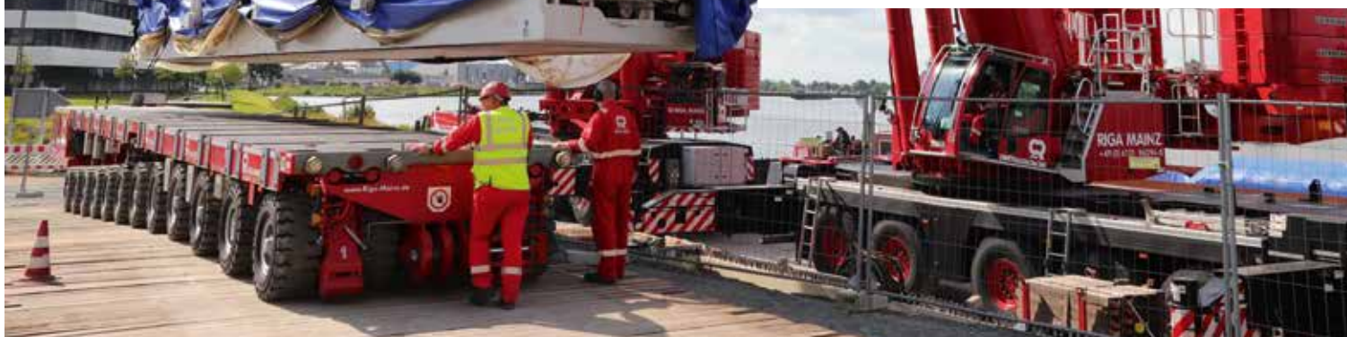
Messen für die genaue Platzierung des Gasmotors auf dem SPMT, dann kann die Last millimetergenau abgesetzt werden
