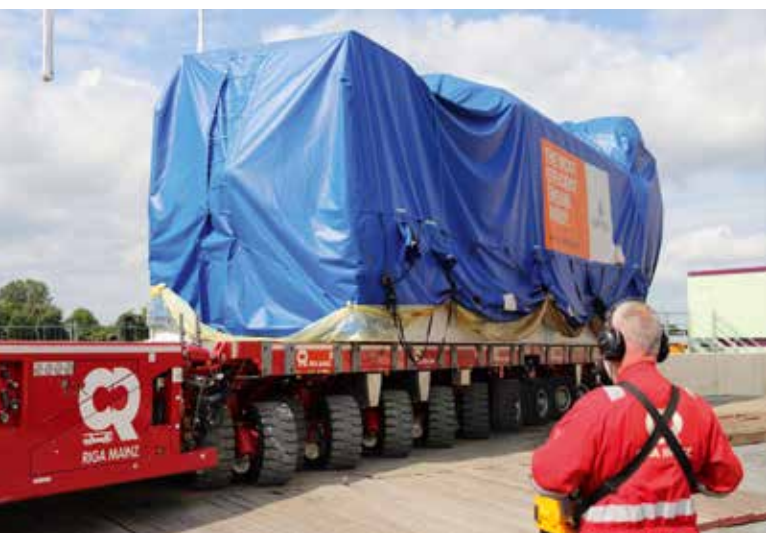
Der hohe Lenkeinschlag ermöglicht geringe Wenderadien.
