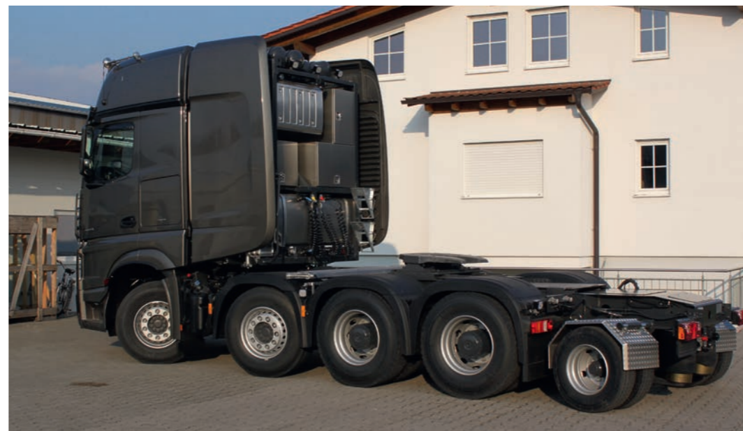
Diese modulare, koppelbare Achse fertigt Titan, um damit aus einem vier- einen fünfachsigem Actros zu erstellen.
