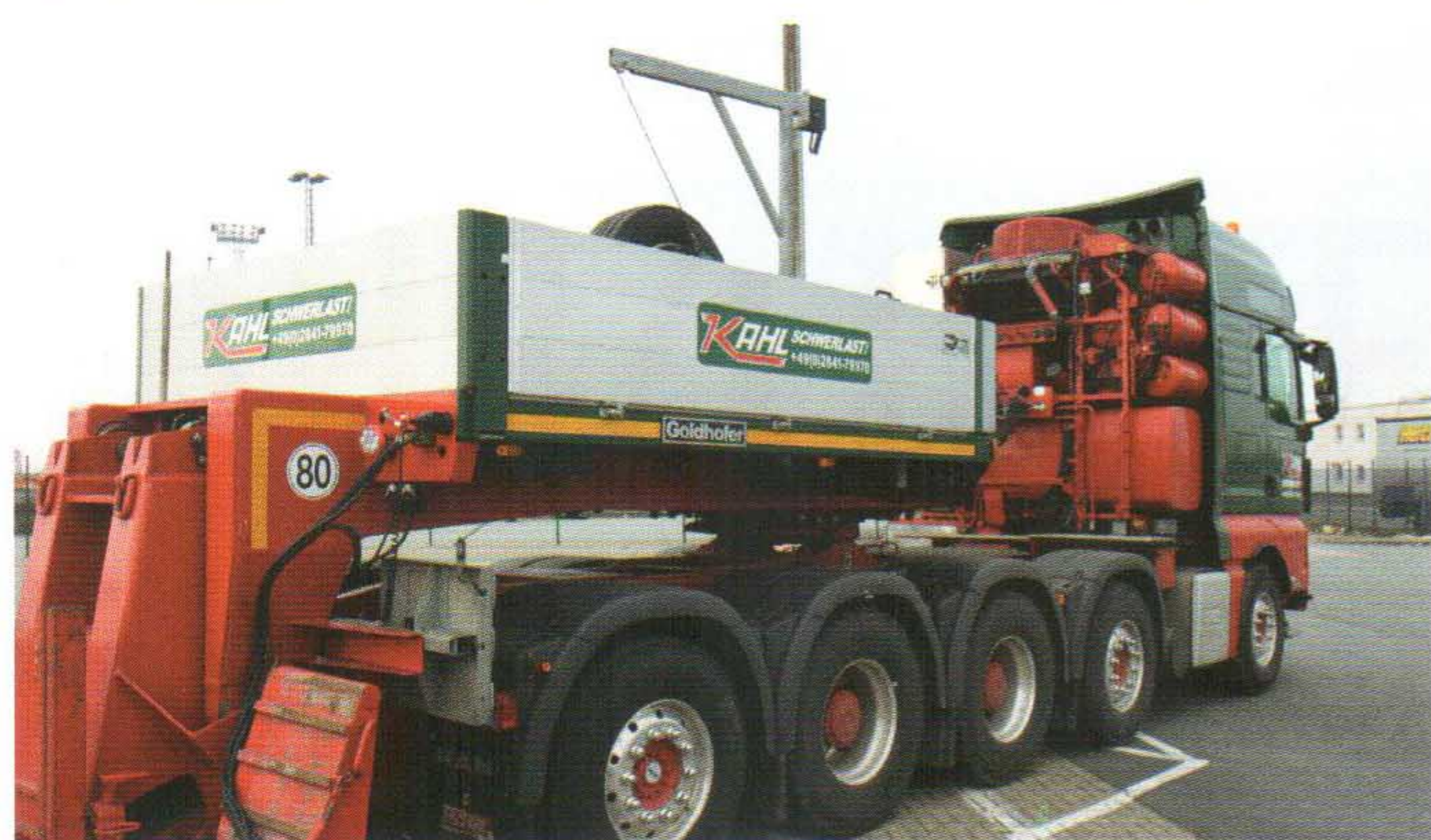
▲ Semitiefloader werden mit unterschiedlichen Achszahlen benötigt, hier mit einem MAN TGA 41.530.
