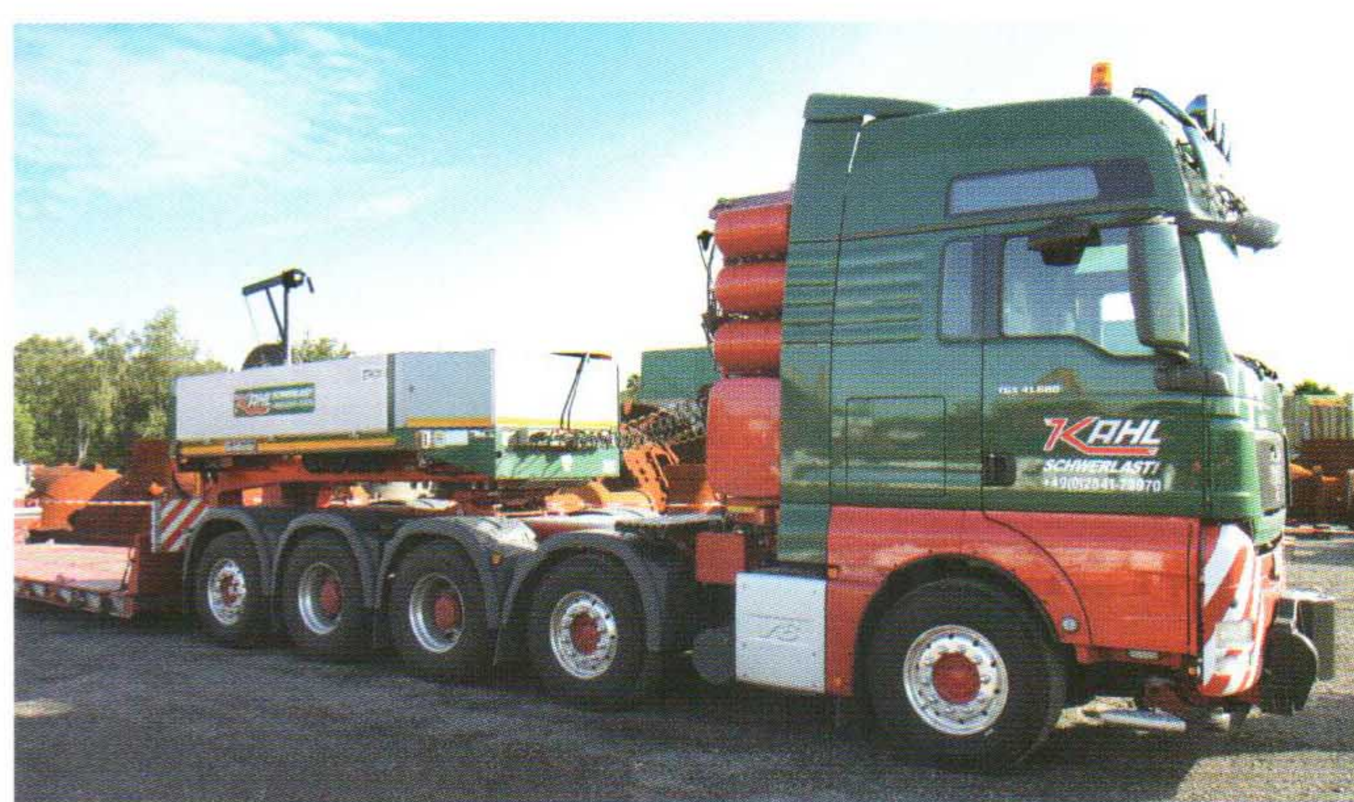
▲ Semitiefloader werden mit unterschiedlichen Achszahlen benötigt, hier mit einem MAN TGA 41.530.
