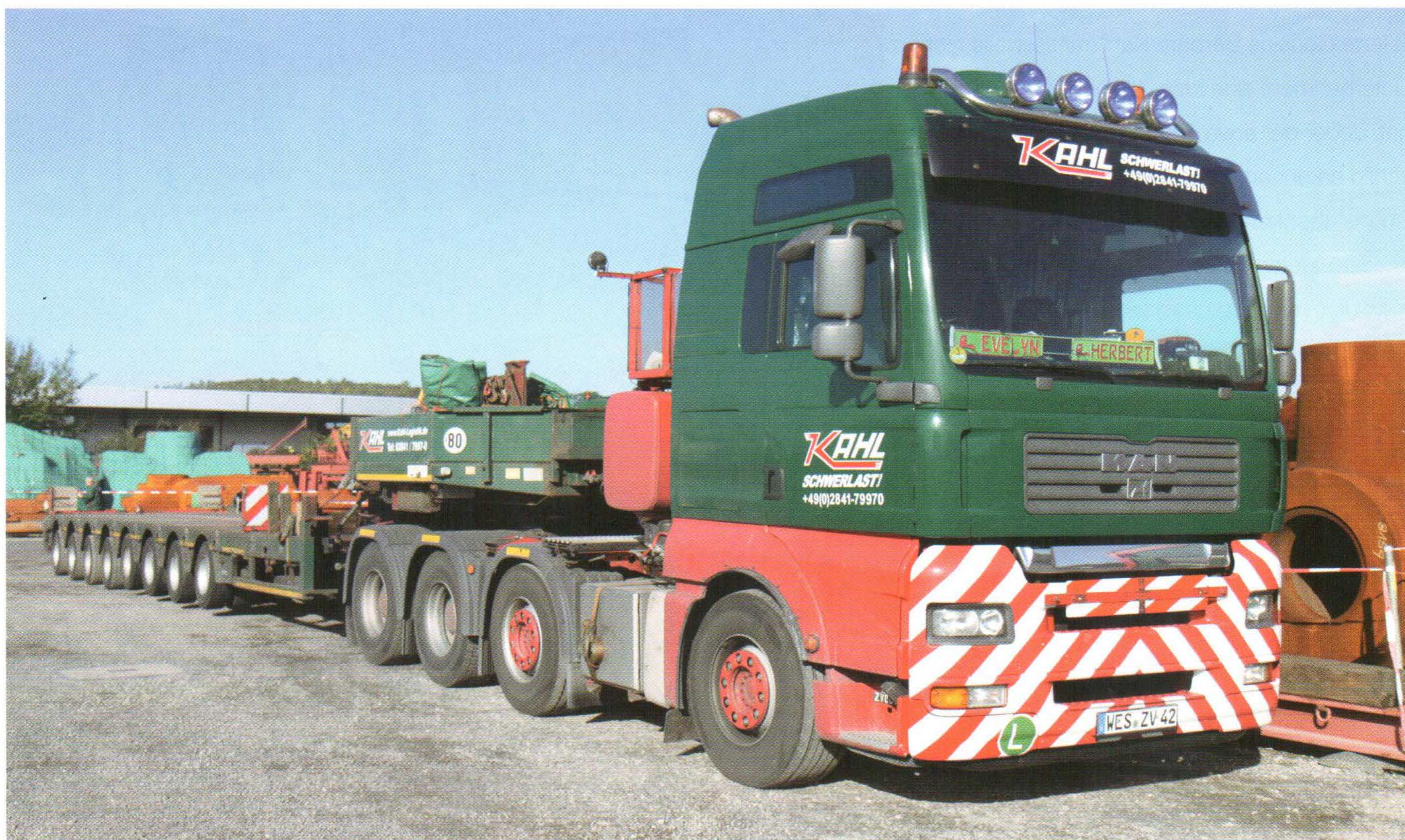
▲ Semitiefloader werden mit unterschiedlichen Achszahlen benötigt, hier mit einem MAN TGA 41.530.
