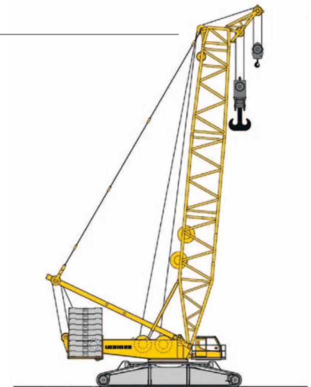
mit zwei Tieflade-Sattelzügen mit den Raupenfahrwerken (Art.-Nummern 302 111 und 302 128). Der Großkran wird in der ersten Ausbaustufe eine Gasamthöhe von etwa 120 Zentimetern haben und so konfiguriert sein, wie es oben in der Abbildung zu sehen ist. Weitere Ausbaustufen, wie auf Seite 28 in unserem Aufmacherbild zu sehen, werden dann Schritt für Schritt folgen. :
