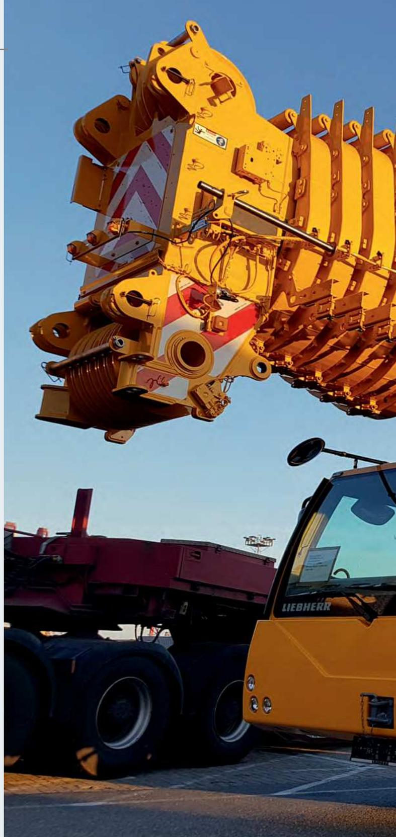
Vorgänger benötigte noch einen separaten 4-Zylinder-Dieselmotor sowie einen zusätzlichen 300-Liter-Dieseltank im Oberwagen. Diese eingesparten Kilos konnten in einen längeren Ausleger und in die Steigerung der Traglast investiert werden. Der Teleskopausleger hat so eine maximale Länge von 78 m. Für zusätzliche Möglichkeiten sorgen verschiedene Gitterspitzen, teilweise sogar mit Wipffunktion. Wer ganz hoch hinaus will, kann mit langer Gitterspitze eine maximale Hubhöhe von 114 m erreichen.
