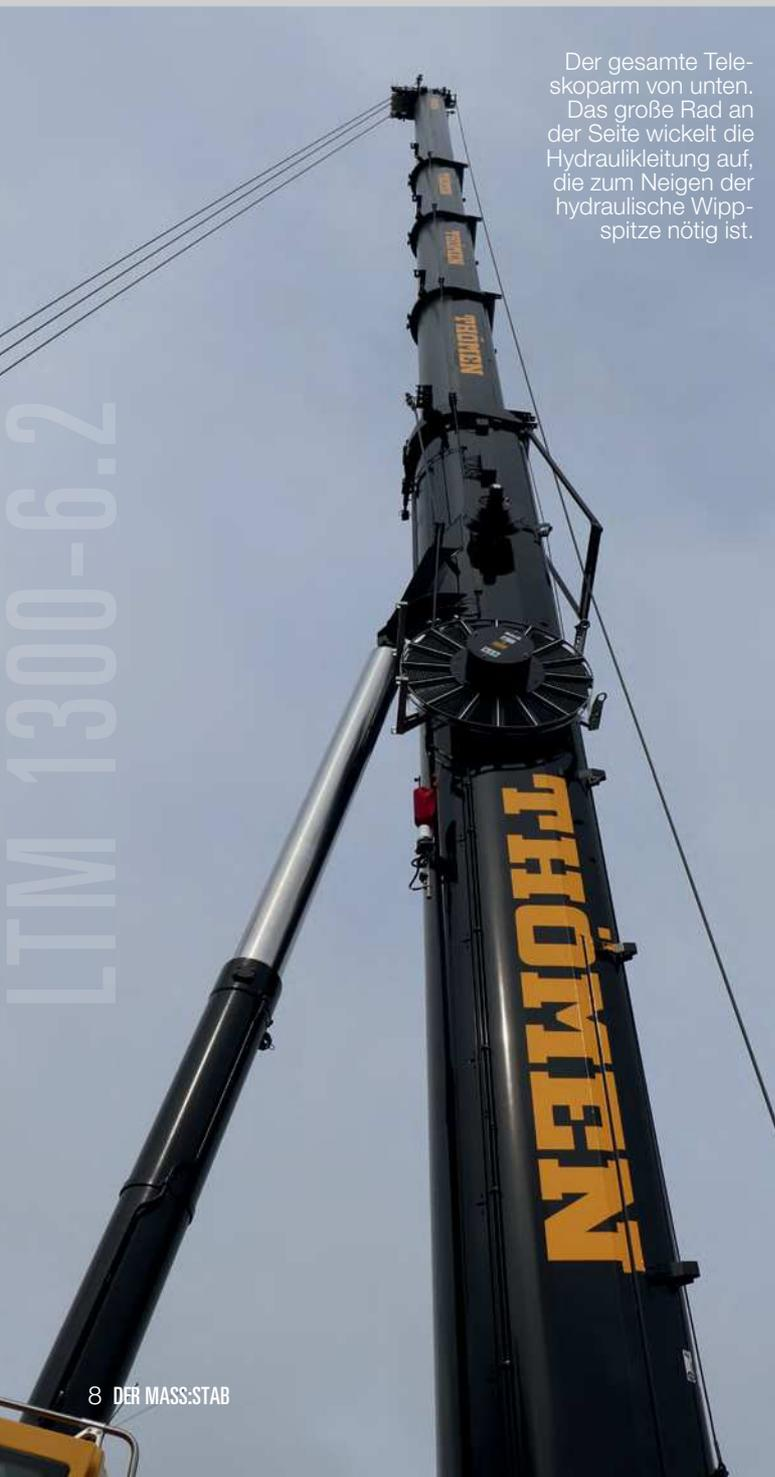
Der gesamte Teleskoparm von unten. Das große Rad an der Seite wickelt die Hydraulikleitung auf, die zum Neigen der hydraulische Wippspitze nötig ist.
