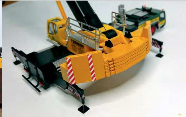
Sicht auf den Ballast (Gegengewichte) – die große untere Platte wiegt 16 t, alle weiteren 10 t. Gut sichtbar sind auch die Halterungen der hochkantigen Ballaste rechts und links (links). Diese hätten zusammen nochmals 40 t Gewicht (rechts beim Herpa-Modell). So kommt man auf ein maximales Gesamtgewicht von 96 t.
