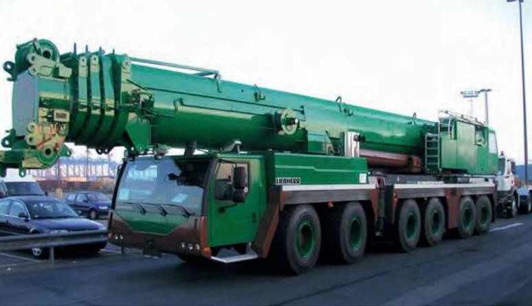
Der Vorgänger, der LTM 1300-6.1. Obwohl er fast 2 m länger ist als der LTM 1300-6.2, ist der Teleskoparm 18 m kürzer. Interessant ist auch die nach hinten geklappte Kabine.
