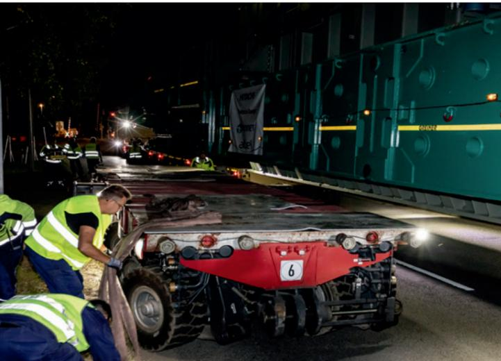
Der fünfachsige Selbstfahrer mit Rutschmatten wird unter den Transformator rangiert.
