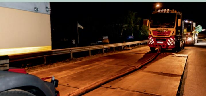
Mit einer 20 Meter langen Textilrundschnur wird der TGX 41.640 8x6 „angekuppelt“.
