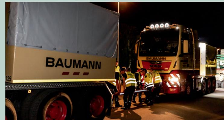
Mit einer stabilen Schlepplaste werden die Zugmaschinen verbunden.
