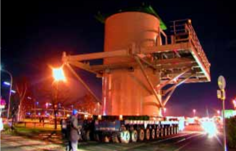
Auf 2x12 Kamag-Achslinien mit zwei Powerpacks wurden die knapp 200 t schwere Gondel und das untere Stahlurmsegment mit der Plattform transportiert. Bild: www.hadel.net
