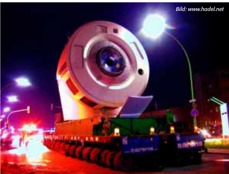
Auf 2x12 Kamag-Achslinien mit zwei Powerpacks wurden die knapp 200 t schwere Gondel und das untere Stahlurmsegment mit der Plattform transportiert. Bild: www.hadel.net
