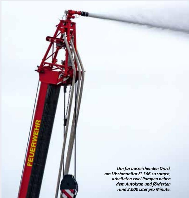
Um für ausreichenden Druck am Löschmonitor EL 366 zu sorgen, arbeiteten zwei Pumpen neben dem Autokran und förderten rund 2.000 Liter pro Minute.
