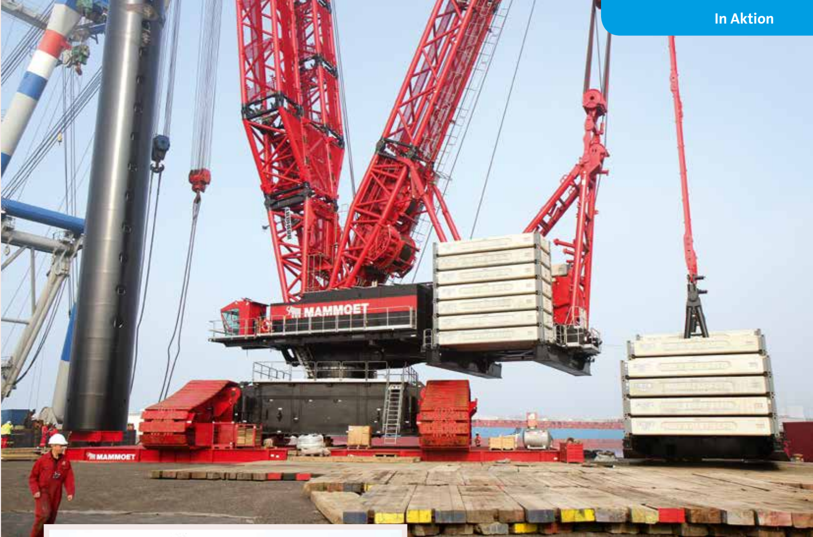
Bei den Hüben lagen nur noch 600 Tonnen auf dem Ballastträger, für das Aufrichten waren 1000 Tonnen nötig.
