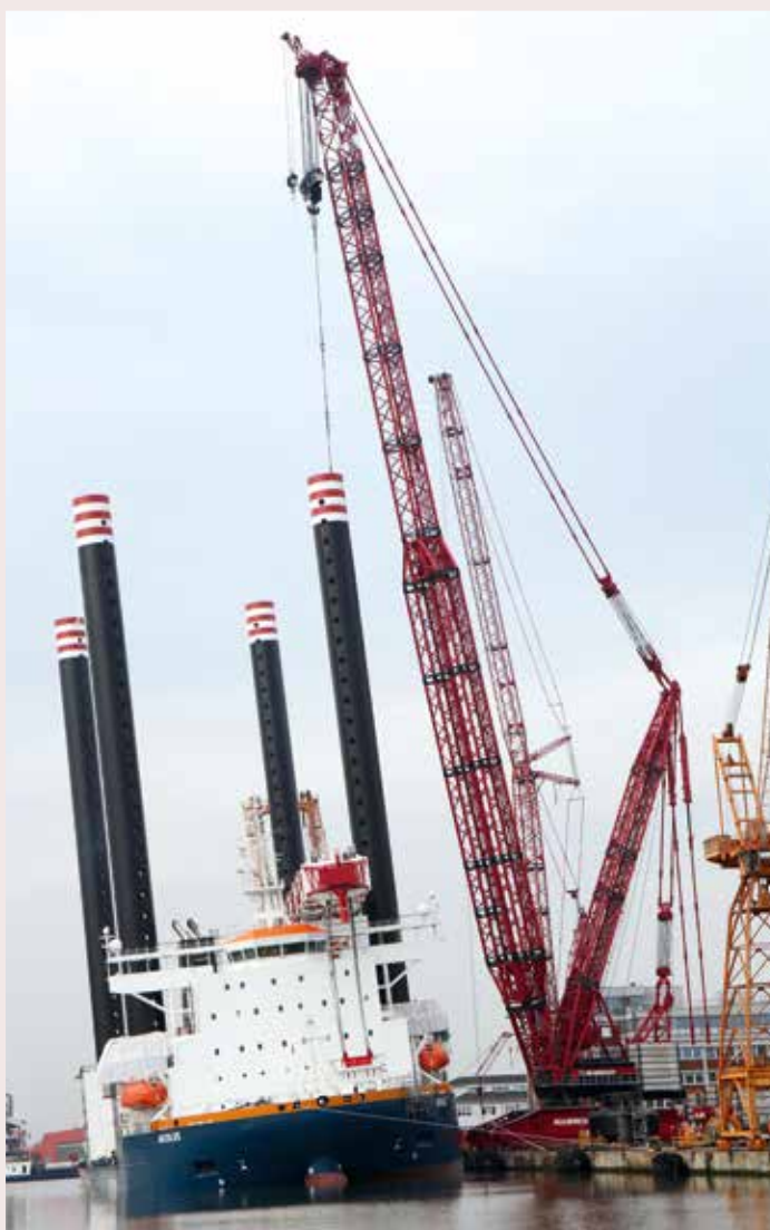
Bei der Fußmontage wurde die Aeolus stark geneigt.
