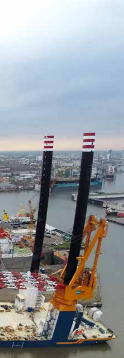
Die Aeolus wird für die Montage der FüÙe absichtlich aus der Waage gebracht.
