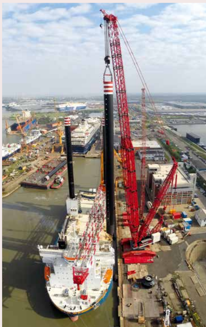
Beim Einsetzen des dritten Standbeins stand der erste Fuß schon neben dem Kran.
