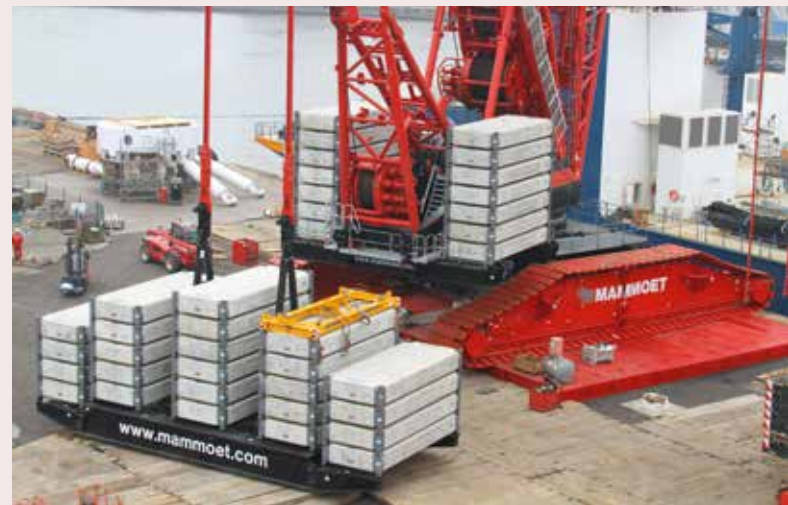
Bei den Hüben lagen nur noch 600 Tonnen auf dem Ballastträger, für das Aufrichten waren 1000 Tonnen nötig.
