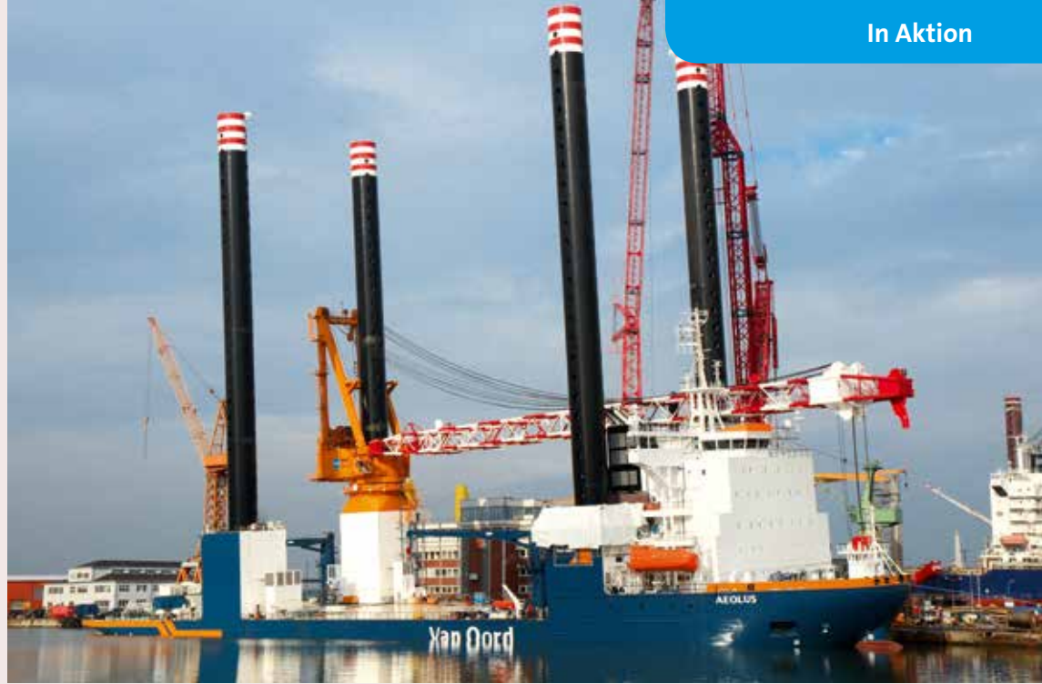
Die Aeolus wird für die Montage der FüÙe absichtlich aus der Waage gebracht.
