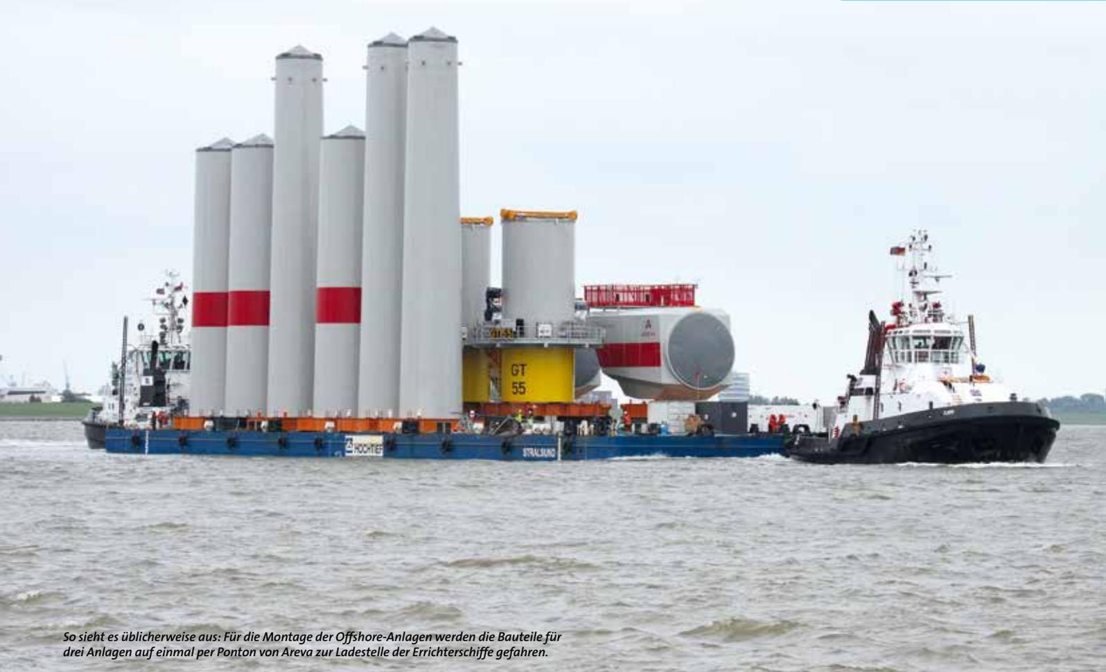
*So sieht es üblicherweise aus: Für die Montage der Offshore-Anlagen werden die Bauteile für drei Anlagen auf einmal per Ponton von Areva zur Ladestelle der Errichterschiffe gefahren.*
