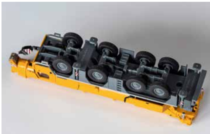
Auch von unten sehenswert: Der Metallguss zeigt Kardanwellen und Achsaufhängungen.
