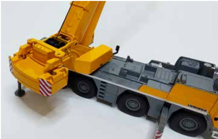
Von oben auf den Unterwagen geschaut: die liegenden Leitern für den Aufstieg, Lüftungsgitter, Motorabdeckung und eine silberne Abgasanlage.
