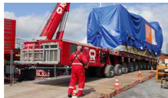
Die Fahrwerkshydraulik der SPMTs gleicht das Ge- fälle der Trasse aus.
