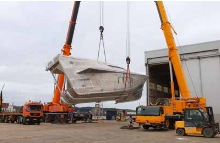
Die Hälfte der Drehung ist fast geschafft, der Rumpf hängt auf die Seite gedreht am Haken des 200-Tonnners.
