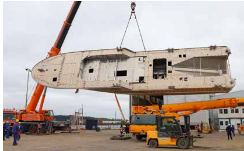
Der Rumpf wird über den 130-Tonner hinweggeschwenkt.
