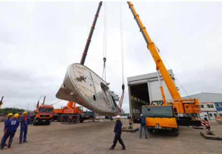
Der 130-Tonner hebt nun die untere Seite des Rumpfs an ...
