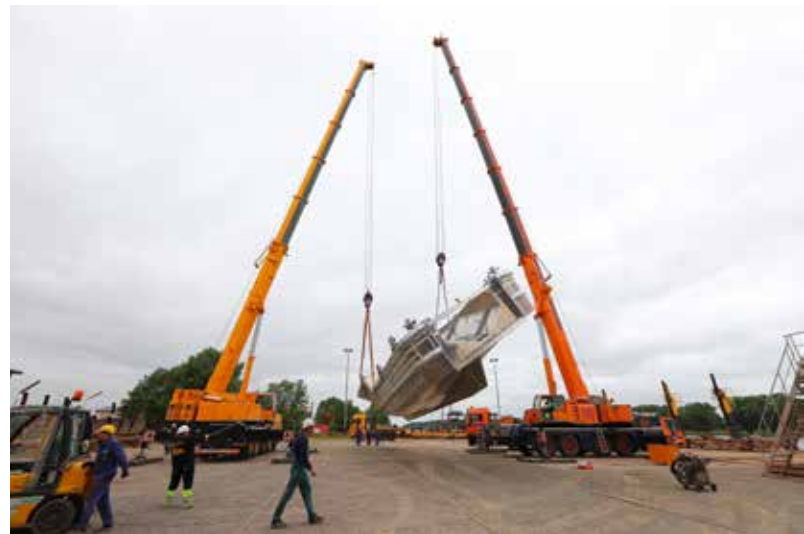
... und der Kiel dreht sich in die vorgesehene Position.
