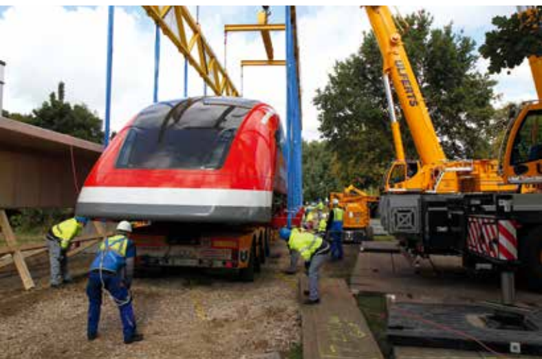
Nachdem Traverse positioniert ist, kann der Transrapid in die Luft gehen.
