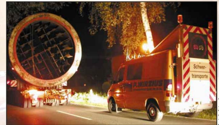
Das BF3-Fahrzeug sichert den rückwärtigen Verkehr. An Überholen ist hier nicht zu denken!
