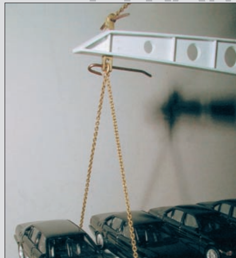
Nicht leicht zu lösen war die Befestigung der Kette am Querträger. Hier die Zwischenlösung mit der Büroklammer.
