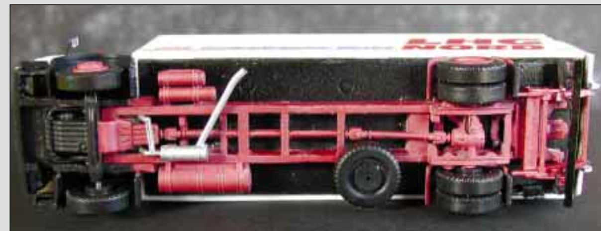
Auch das Fahrgestell mit der Kardanwelle mußte verlängert werden. Dazu wurden Profile von Evergreen verwendet.
